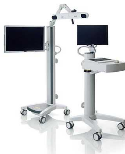
膝関節用ロボティックアーム (左) カメラスタンド (中央) ガイダンスモジュール (右)
